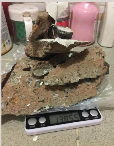
■ 單位出現石屎及天花混凝土剝落、鋼筋外露和漏水等結構性問題
